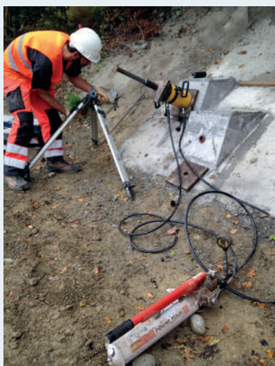
Essai de traction sur clou
